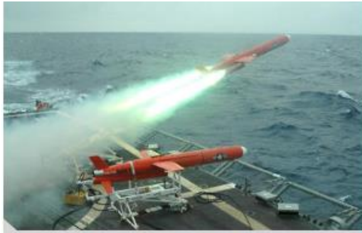
Figura 8. Tipo de drone empleado como blanco en tiro Antiaéreo.
