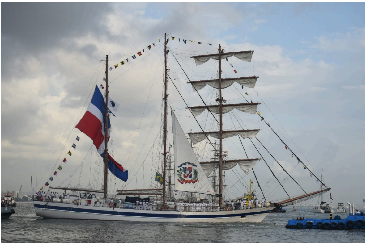
El buque escuela "Almirante Juan Bautista Cambiaso" BE-01, de la Armada de República Dominicana Eslora 178 pies, Manga 27 pies, Calado 12,9 pies, Tripulación: 53 Cadetes y Guardiamarinas, 9 femeninas.
