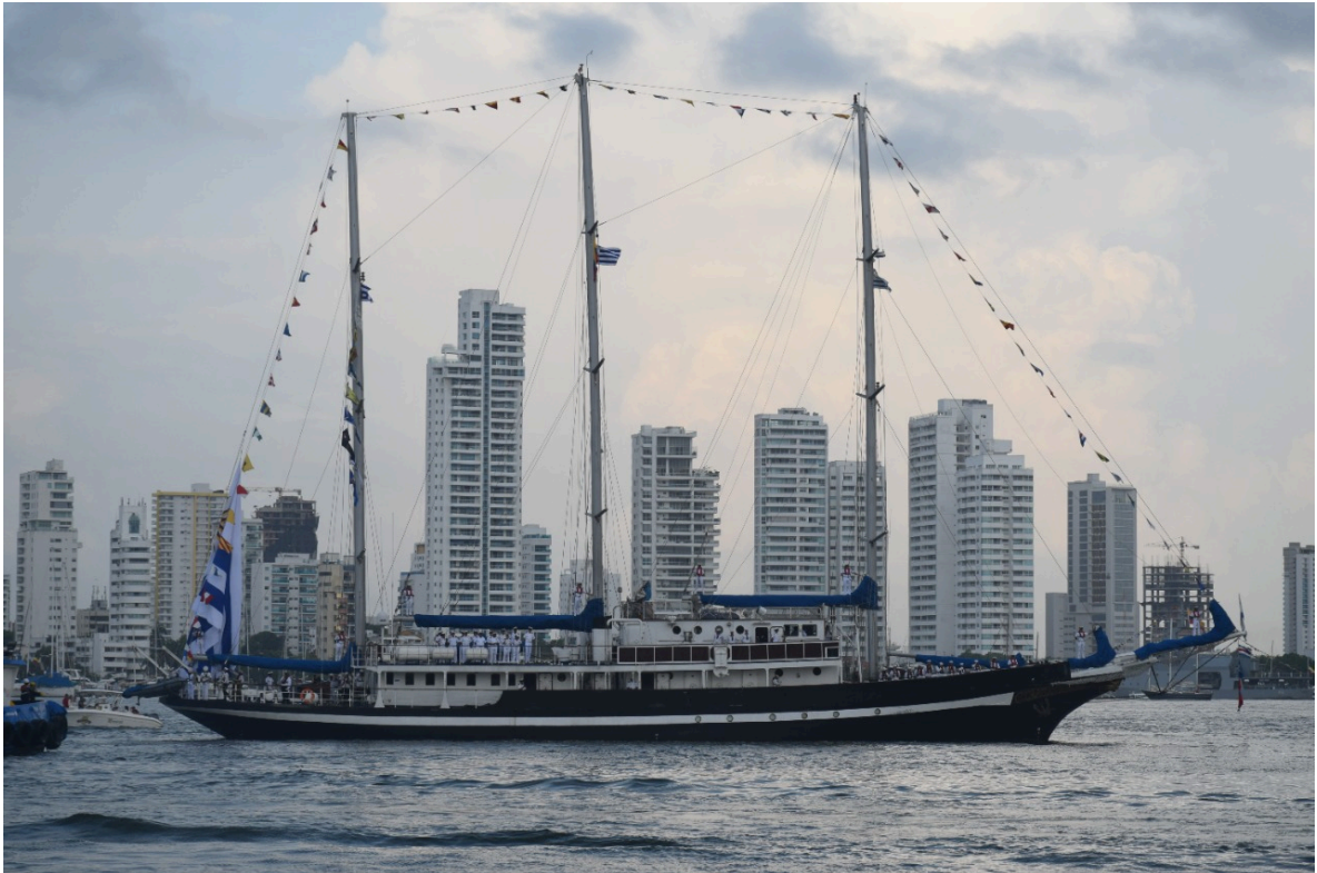
El "Capitán Miranda" (ROU-20), Buque Escuela de vela de la Armada Nacional del Uruguay Eslora 64 metros, Manga 8 metros, Calado 3,80 m, Desplazamiento 839t, Tripulación: 12 Oficiales, 16 Guardiamarinas, 39 Personal Subalterno
